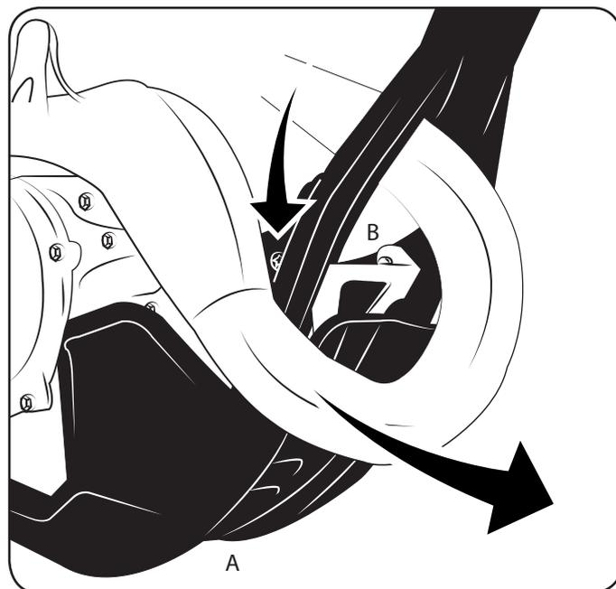
1. Scollegare lo scarico e spostarlo avanti per facilitare il montaggio della staffa sul telaio.
